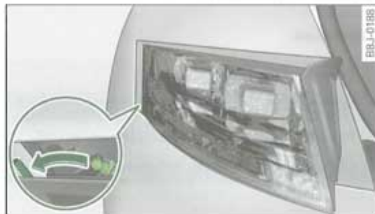
Fig. 198 Mise en place du feu arrière
