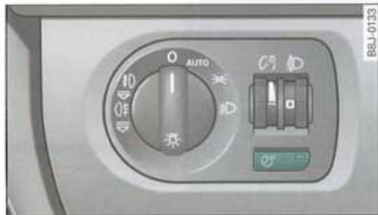
Fig. 52 Vue partielle du tableau de bord : commande coming/leaving home
