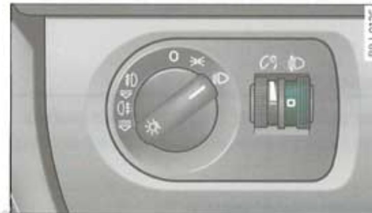
Fig. 54 Réglage du site des phares
