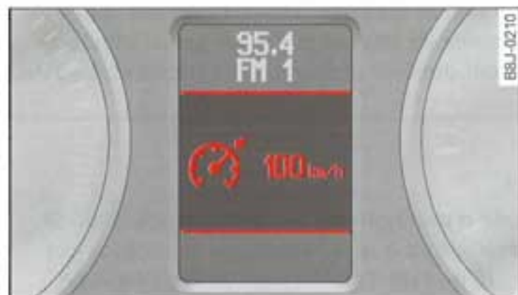
Fig. 98 Affichage du symbole et de la vitesse en mode de régulation (affichage bref)
