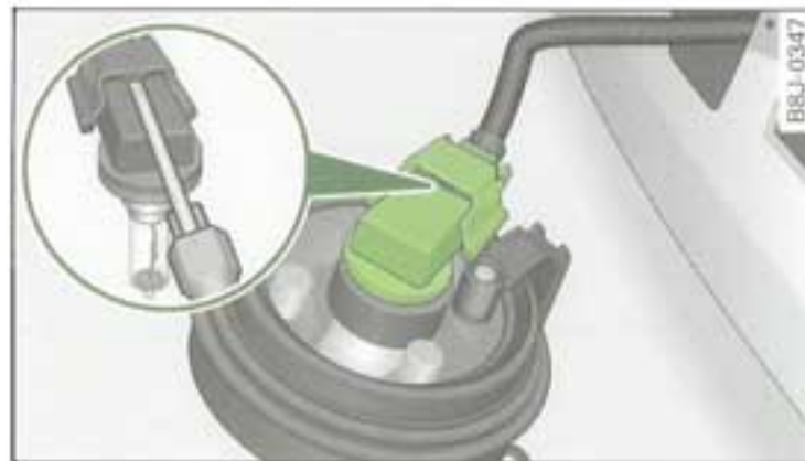
Fig. 202 Boîtier du phare antibrouillard déposé
