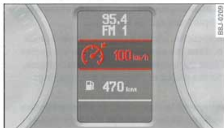
Fig. 97 Affichage du symbole et de la vitesse en mode de régulation (affichage permanent)
