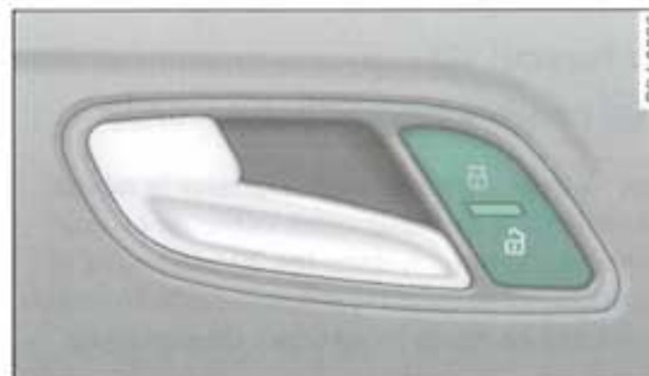
Fig. 38 Vue partielle de la porte du conducteur : commande de verrouillage central
