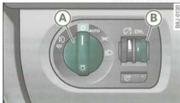
Fig. 49 Feux de jours avec la commande DRL, uniquement sur les véhicules avec phares bi-xenon
