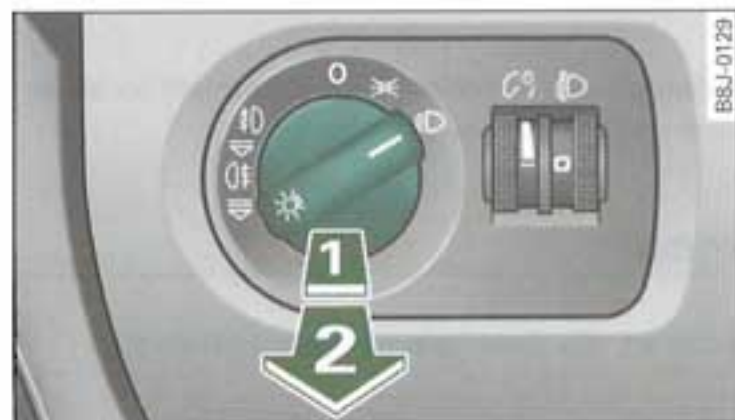
Fig. 48 Vue partielle du tableau de bord : commande d'éclairage
